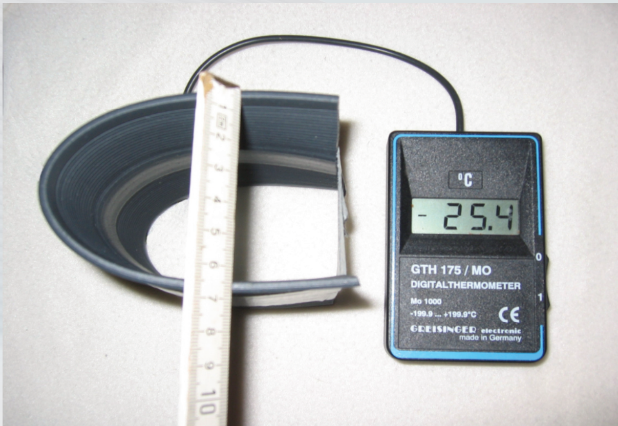
Biegeverhalten der TopFuge nach 2 Jahren bei -25,4 Grad
